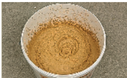
Après 30 minutes, remélanger vigoureusement, la photo montre la consistance du mortier prêt à l'emploi.
